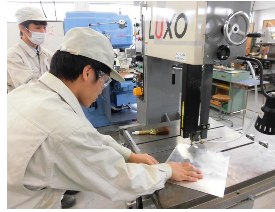
コンタマシンで 切断作業
