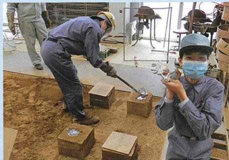
金属を溶かして形にする casting
